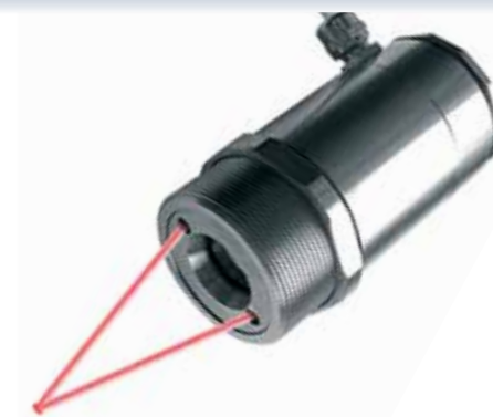
Dvojitý laserový zaměřovač pro přesné vyznačení měřicí plochy v každé vzdálenosti, např. 0.5 mm ve vzdálenosti 150 mm
