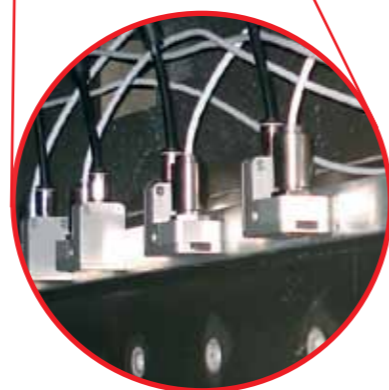
Malé Optris CT LT měřící hlavy s laminární vzduchovou předsádkou, instalované ve stroji
